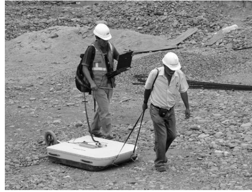
Figura 1: Características del suelo de Lima, su excavación y determinación de estratigrafía con radar.
