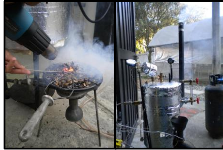
Ilustración 5 Ensayo de desempeño Térmico de la Caldera
