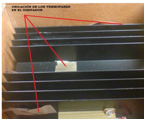
Figura 7: Ubicación de los termopares sobre el disipador de calor.
