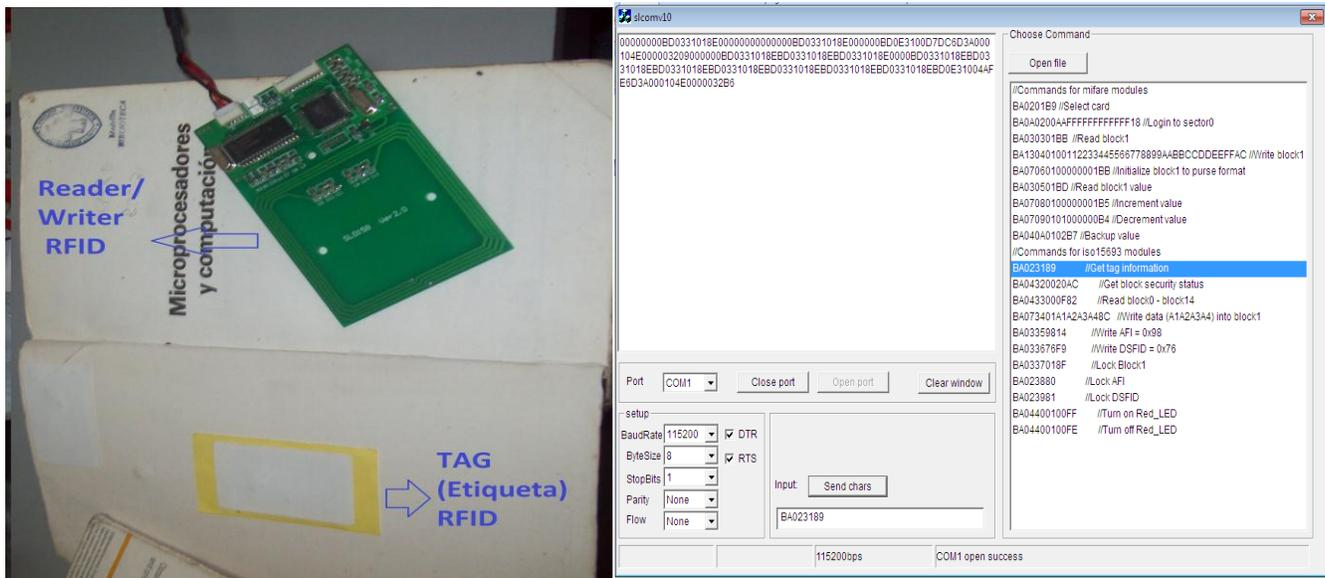
**Figura 13: Libro con TAG tipo RFID y pruebas con la interfaz de usuario del reader/writer**
