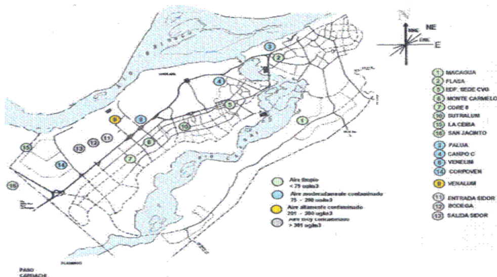
Figura 5. Estaciones de monitoreo de la red de calidad del aire de Ciudad Guayana
