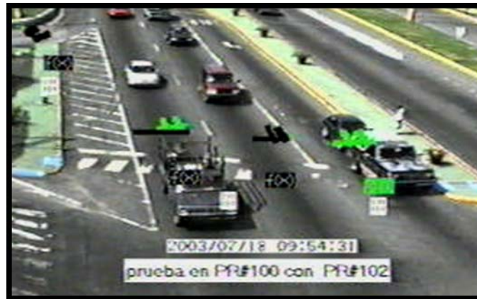
Figura 7 Imagen y detectores de Autoscope ® en la Int. de la PR-100 con PR-102.
