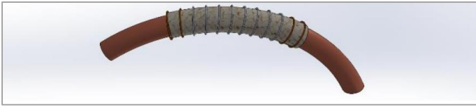
Fig. 7. Alambre de nicrom, aislante de vidrio y alambre de cobre.
