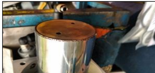
Fig.14 Presencia de óxido y agua en vástago de pistón
