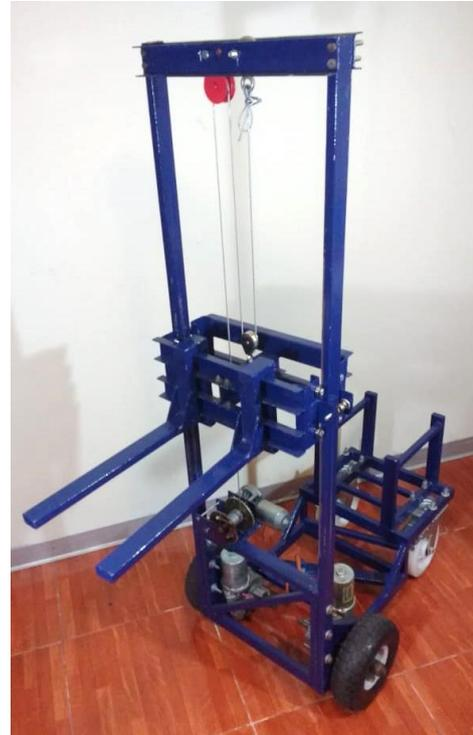
Fig. 19 Vista Isométrica del prototipo
