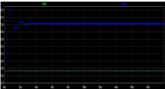
Figura 12. Regulador 7.2V - Vin vs Vout.
