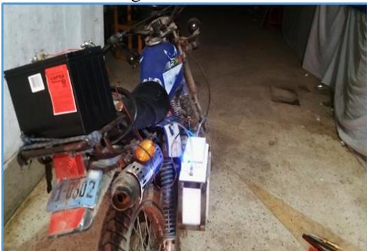
**Figura 11.** Adaptación del sistema generador de gas oxhídrico a bordo del vehículo.
