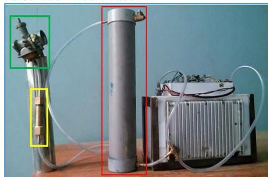
**Figura 10.** Recorrido del gas oxhídrico para la suministración al vehículo.
