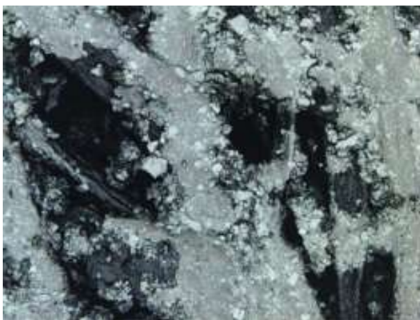
Fig.5 Microscopia electronica de varredura para o grafite sobre papel, determinação do tamanho das lâminas. Aumento de 8000x
