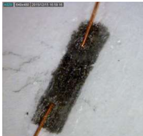
Fig.2 Fotografia digital do piezoresistor de grafite sobre papel.
