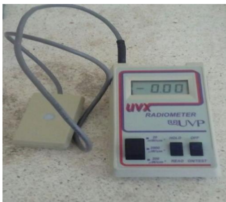
Fig. 2 Radiómetro utilizado para medir la intensidad de radiación ultravioleta de la lámpara.
