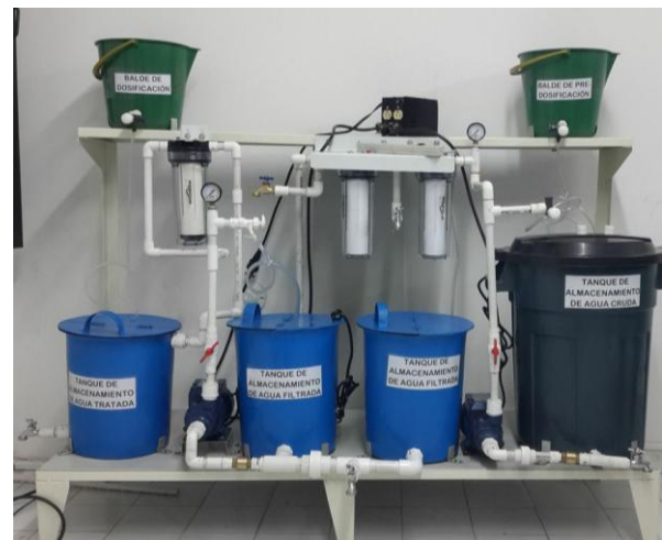
Fig 4. Planta piloto de membranas de filtración (nuevos cartuchos).
