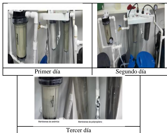
Fig 6. Membranas de microfiltración a culminación de cada uno de los ensayos realizados.
