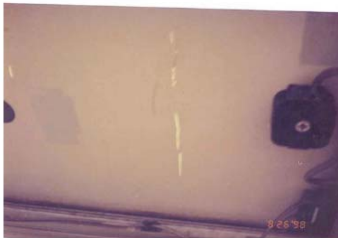
Figure 7: Detalle de fisura del material posterior de módulo fotovoltaico. Note que la luz solar atraviesa el módulo.
