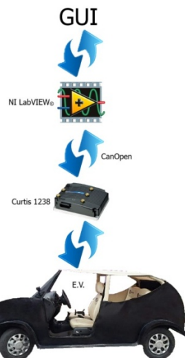
Figura 5: Flujo de Información entre el diseño eléctrico y mecánico
