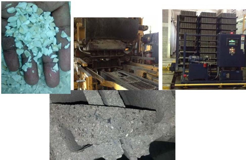
**Imagen 1: Proceso simplificado desde adquisición de ABS triturado, fabricación y curado del bloque, hasta ensayo de resistencia a compresión donde se muestra un fragmento de bloque con ABS al 40%**
