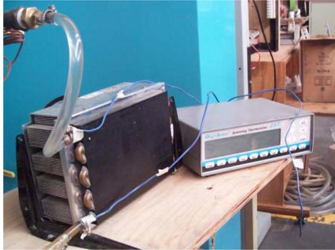
**Figura 3: Banco de pruebas del enfriador de estado sólido donde se simularon las condiciones a la salida del condensador**
