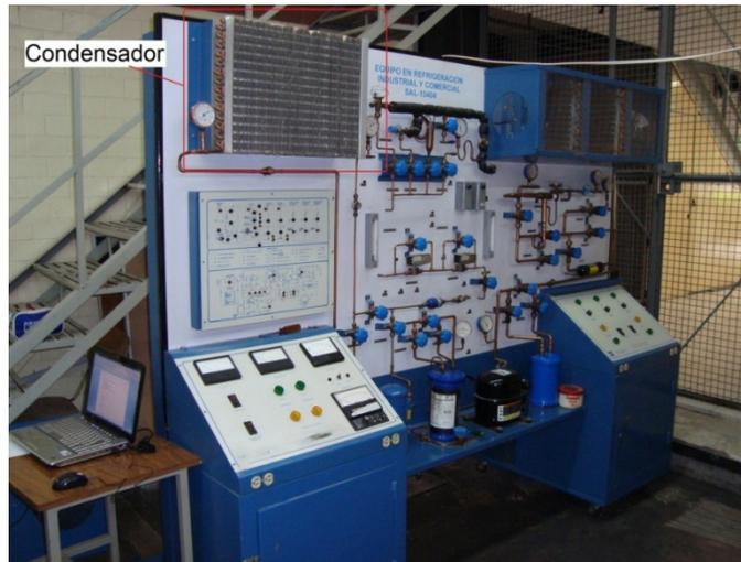
**Figura 2: Banco de pruebas para refrigeración por compresión de vapor**
