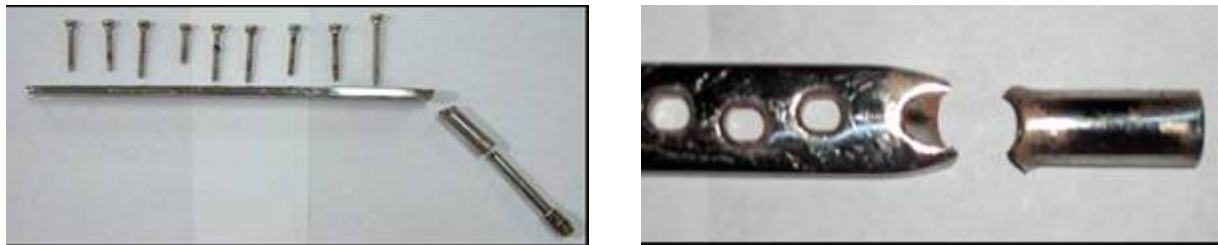
Figura 2: Detalles del sistema fracturado a) fractura en la zona de cambio de sección, b) Detalle de la falla en agujero de cambio de sección.
