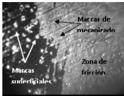
Figura 4: Marcas superficiales en zona cercana al origen de la fractura
