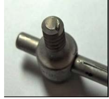
Figura 13: Fractura de tornillo #3
