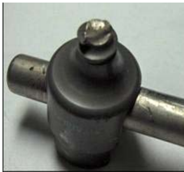
Figura 12: Fractura de tornillo #2
