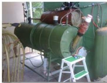
Planta -TANQUE METALICO-para Biogas 1
