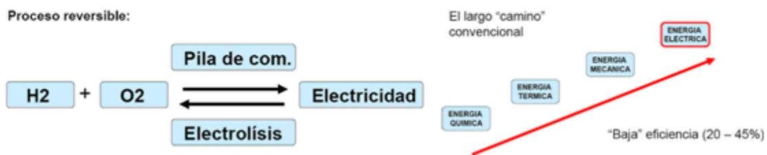
Figura 2: Proceso de conversión energética de una Celda de Combustible-Camino largo
