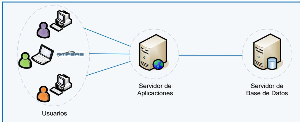
**Figura 5. Estructura multinivel del Sistema.**
