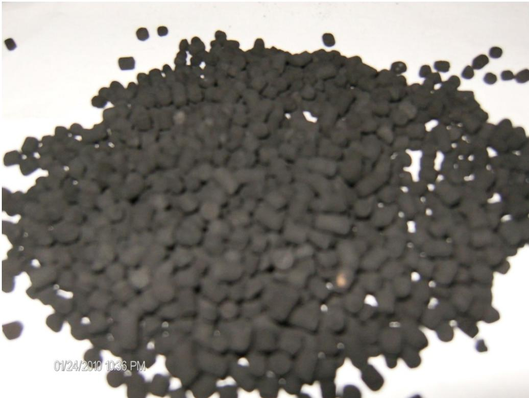
**Figura 4: Pellets de Carbón Vegetal**
