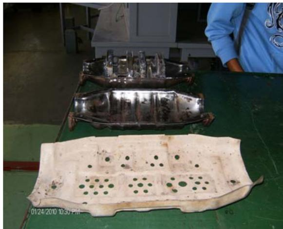
**Figura 2: Componentes Externos del Catalizador**
