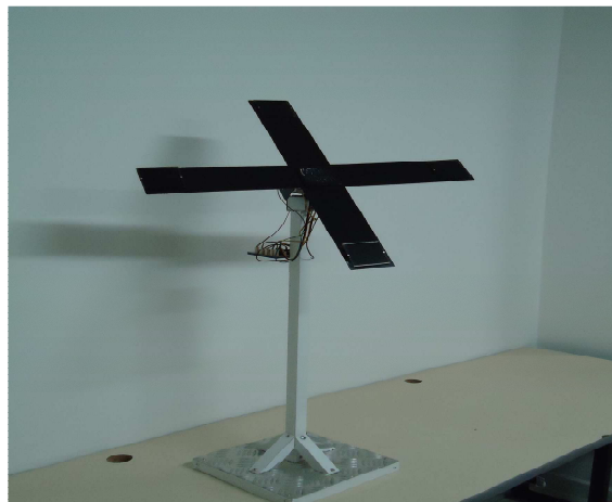
Figura 4. Sistema diseñado de posicionamiento de dos ejes con celda solares
