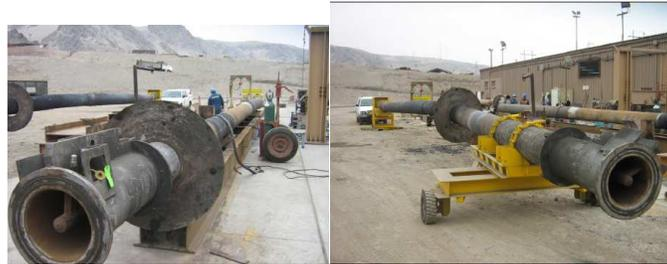
**Figura 3: Deformaciones en el cuerpo de la Lanza**
