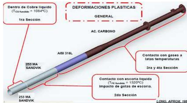
**Figura 4: Partes que conforman la Lanza**
