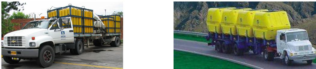
Figura 2. Vehículos de transporte analizados, pesado (3 ejes) y articulado (5 ejes).
