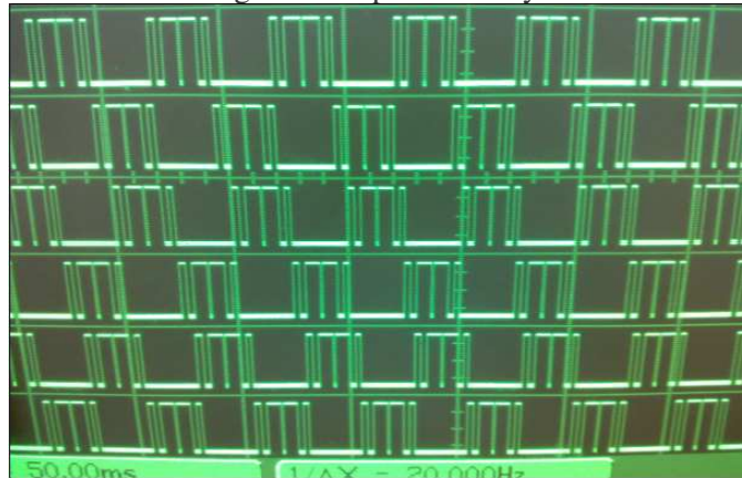
Figura 9. Señales de la modulación PWM optimizada generadas con el DSP para un n_p=4 .
