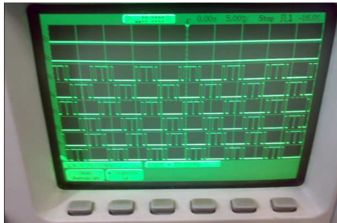
Figura 10. Señales de la modulación PWM optimizada generadas con el DSP para un n_p=5 .
