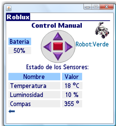
Figura 2: Aplicación para el control remoto de los robots vía PDA.
