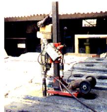
**Figura 7. Máquina probeteadora**
