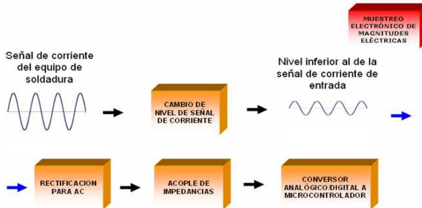
Figura 2. Diagrama en bloques de la etapa de muestreo electrónico de magnitudes eléctricas.
