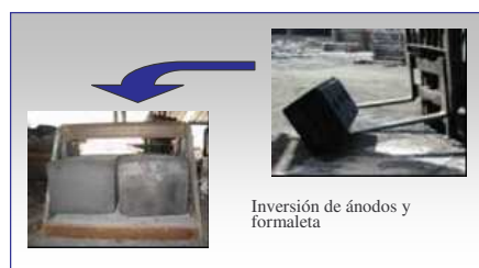
Figura 6.- Posicionamiento de ánodos
