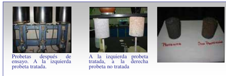
Figura 3. Ensayo de reactividad el aire de muestras tratadas y no tratadas respectivamente.
